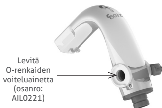
Kuva 11. Voideltava kiinnikerengas
